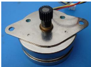
Рис. 8.67 Биполярный шаговый двигатель AIRPAX LB82773-M1
