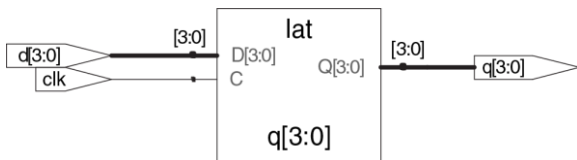
Рис. 4.19 Синтезированная схема модуля latch
