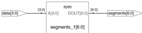
Рис. 4.20 Синтезированная схема модуля sevenseg
