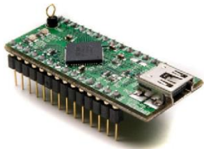
Рис. 8.76 Модуль FTDI UM232H
